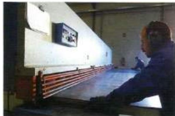
A **METALL-LÒGIC** resolem, amb la maquinària adient, les necessitats dels nostres clients, tant en el tall de la xapa, amb una capacitat de 6 m de llargada i 10 mm de gruix, com en el plegat, disposant de màquines fins a 250 TM de potència.
